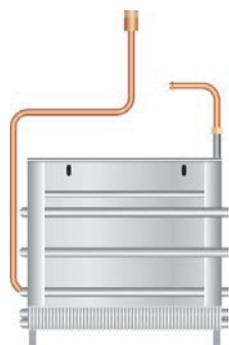
В газовых водонагревателях NOVA TEC используется массивный теплообменник из луженой меди. При производстве теплообменника «NOVA TEC» применяется чистая красная медь и специальный лудильный состав на основе олова с добавлением серебра. Масса меди в теплообменнике для колонки мощностью 20 кВт – более 3 кг.
