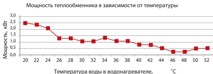
Данный график представляет зависимость мощности теплообменника от температуры воды в водонагревателе. Данные получены при следующих условиях:
