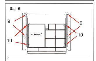
Установите выдвижной ящик (D). Используя винты (10) к направляющим..Прикрепите конструкцию к столешнице винтами (9).
