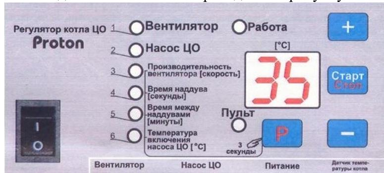
Рисунок 3 – Зовнішній вигляд передньої панелі контролера
