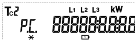
Рисунок 2.12- Перегляд параметрів реле керування навантаженням
