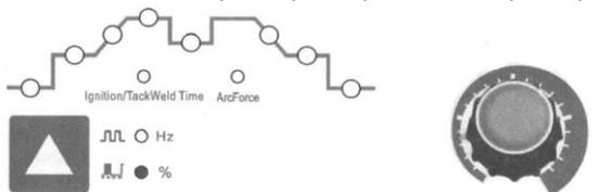
**6.6.11)** Нажатием кнопки управления в зоне настройки параметров сварочного цикла выберите параметр «частота импульсов» (18). Установите значение этого параметра в процессе сварки, вращая рукоятку задания параметров (4)
