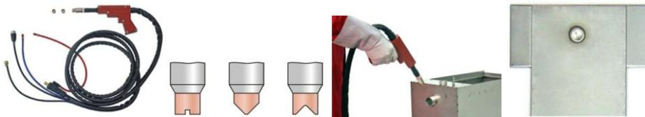
Данный вид сварки используется при прихватке и соединении стальных листов и хромоникелевых сплавов толщиной до 2,5 мм.
