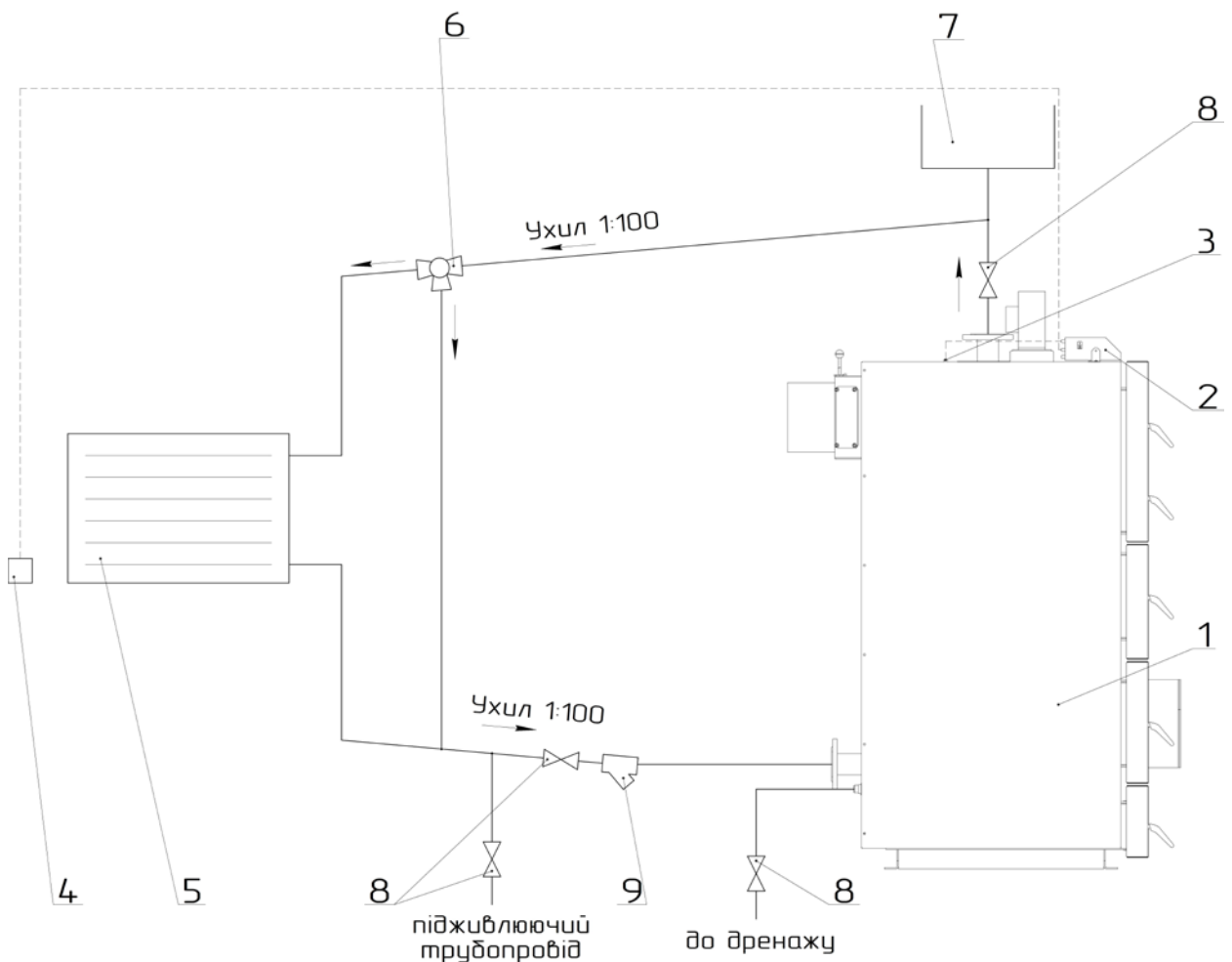
Рисунок 4 – Схема підключення котла до системи опалення з природною циркуляцією теплоносія
