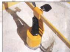
Сухой зонд служит для измерения уровня в бункере с материалом
