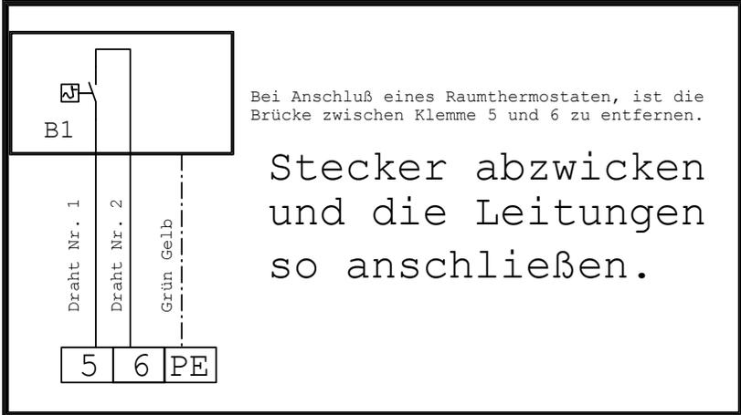
Stecker abzwicken und die Leitungen so anschließen.
