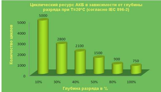
**Производительность в циклическом режиме**
