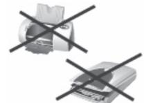
**ВНИМАНИЕ: НИКОГДА** не подсоединяйте лазерный принтер или сканер к устройству ИБП. Это может привести к повреждению устройства
