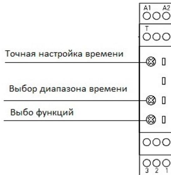
Порядок настройки и использования реле времени очень простой. Сначала устанавливаете с помощью нижнего кругового селектора "Fn" нужную функцию, затем с помощью среднего кругового селектора "tm" временной диапазон и с помощью верхнего кругового селектора "Xn" временной коэффициент.
