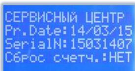
Рис. 31 – Вывод служебной информации об оборудовании
