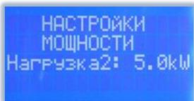
При помощи меню **1.3.1 Мощность** производится настройка потребляемой мощности ступеней электрических нагревателей:
