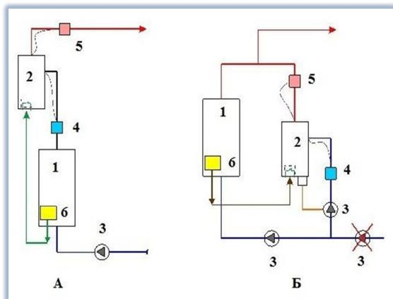
Рис. 4 – Комбинированное отопление. Схемы подключения электрокотла
