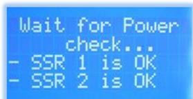
Рис. 7 – Экран проверки питания и твердотельных реле (SSR)
