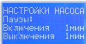
Рис. 14 – Экран настройки режима работы циркуляционного насоса
