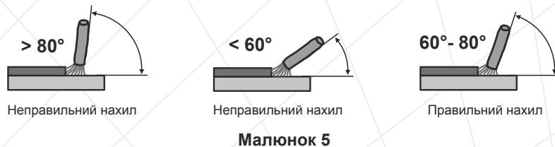
Довжина електрода в процесі зварювання зменшується. Коли довжина електрода досягає 15-20 мм, припиніть зварювання та замініть електрод.
