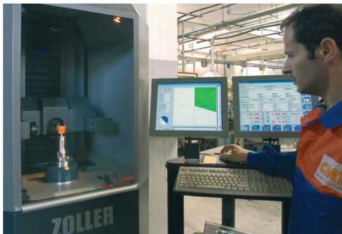
Полностью автоматизированная система измерения CMT.
