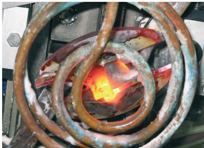
680°C - несколько секунд - и пайка завершена.
