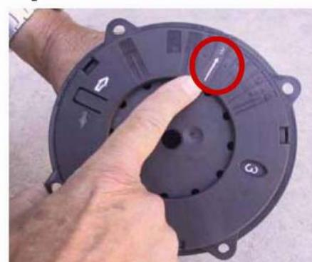
Для регулировки: перемещение верхней пластины с обозначением значений.
