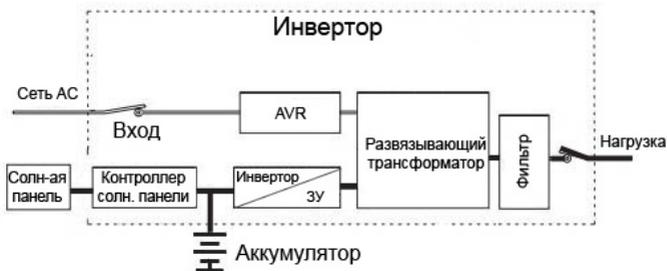
2) При недостаточном освещении солнечных панелей, но нормальном напряжении в сети, контроллер будет обеспечивать питание в первую очередь через аккумулятор, а когда заряд опустится до нижнего порога, перейдет на питание от сети, одновременно заряжая аккумулятор до значения, достаточного для функционирования в резервном режиме. Полная зарядка аккумулятора будет продолжена после возобновления достаточного освещения.
