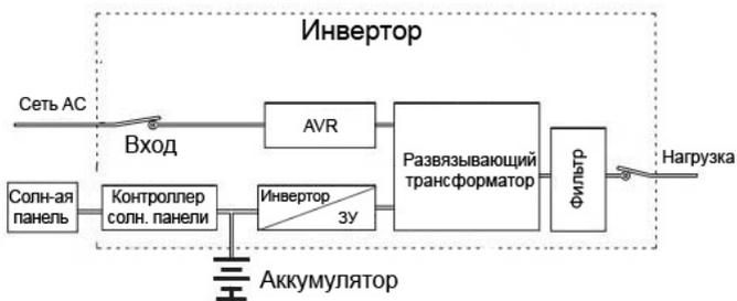
2) При прекращении подачи питания с сети АС, либо выходе значений питания за допустимые характеристики: устройство переводит подключенное оборудование на работу от солнечных панелей/аккумулятора. В случае, если нагрузка на устройство превышает отдачу солнечных панелей, нагрузка перераспределяется на аккумулятор.
