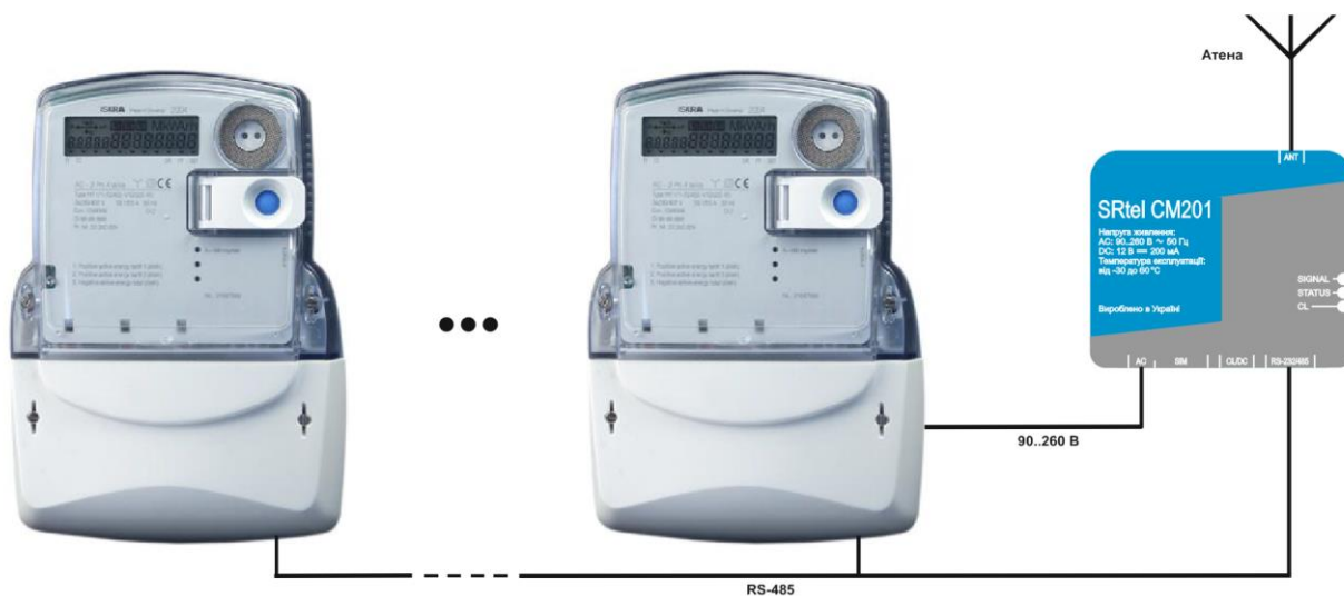
Рис.5.4. Пример подключения GSM модема к счетчику (цепочке счетчиков) через интерфейс RS-485.
