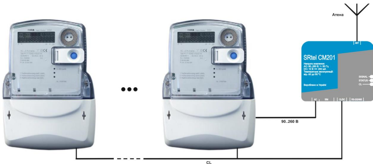
Рис.5.5. Пример подключения GSM модема к счетчику (цепочке счетчиков) через интерфейс CL.
