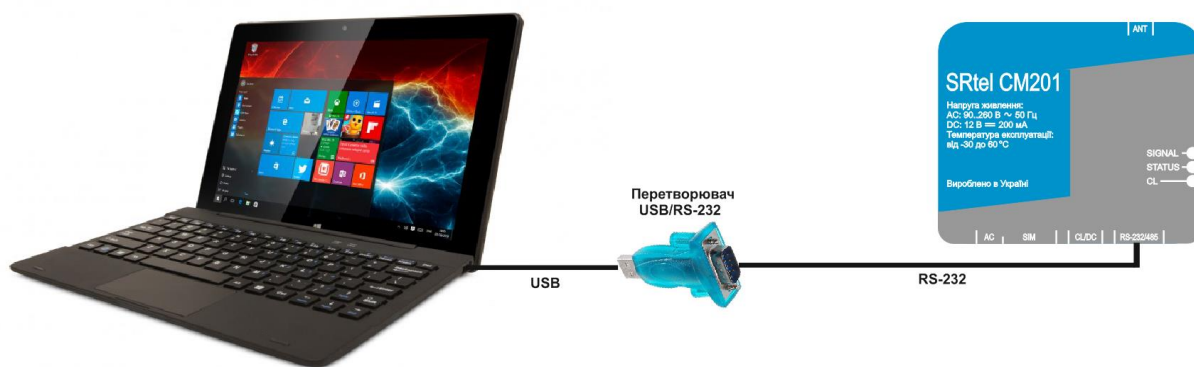
Рис.5.2. Схема кабеля для подключения к COM порту ПК.
