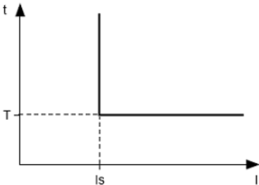
Рисунок 1.4. Принцип защиты с независимой выдержкой времени
