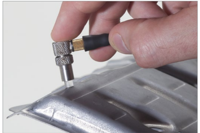
Измерение утонения металла после формования.
