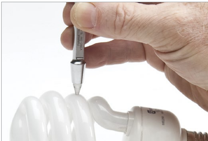
Измерение тонкого стекла с помощью преобразователя V260-SM Sonoren®
