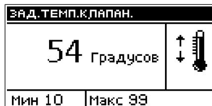
При помощи этой опции устанавливается заданная температура, которую должен поддерживать клапан. При правильном функционировании температура воды за клапаном будет стремиться к заданной клапану температуре.
