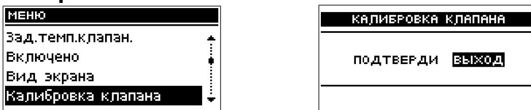
При помощи этой функции регулируются начальные установки клапана. Во время калибровки клапан устанавливается в безопасную позицию, то есть для клапана ЦО в позицию полного открытия, а для клапана обогрева пола в позицию закрыто. Во время проведения калибровки внизу экрана высвечивается символ: ►—T—..
