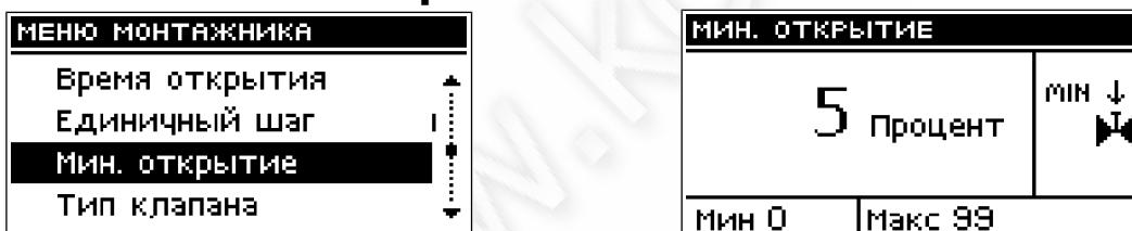
Параметр устанавливает, какое открытие клапана может быть минимальным. Благодаря этому параметру можно оставить клапан минимально приоткрытым, чтобы сохранялась минимальная циркуляция.
