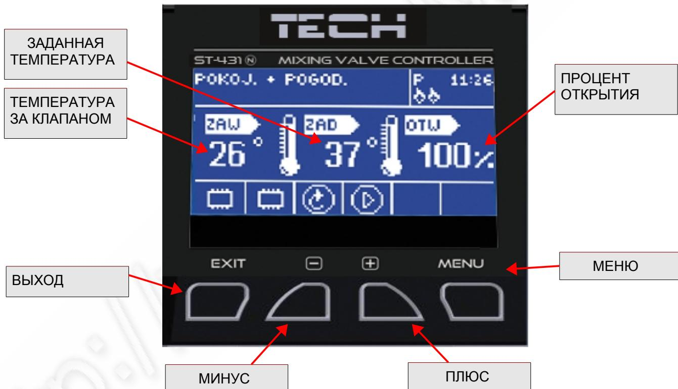
Принцип воздействия пульта управления на сервомотор клапана основан на смещивании питающей циркуляционной горячей воды с водой, которая возвращается из цикла подогрева, чтобы установить требуемую температуру и постоянно удерживать ее на одинаковом уровне.
