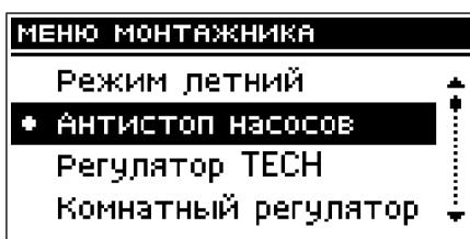
После подключения этой опции насос клапана будет включаться через каждые 10 дней на 2 минуты. Это предотвращает застаивание воды в оборудовании вне отопительного сезона.
