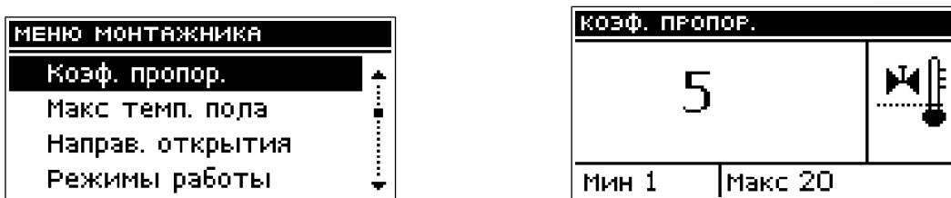
$(\text{ЗАДАННАЯ\_ТЕМП.} - \text{ТЕМП.\_ДАТЧИКА}) * (\text{КОЭФ.\_ПРОПОРЦ.} / 10)$
