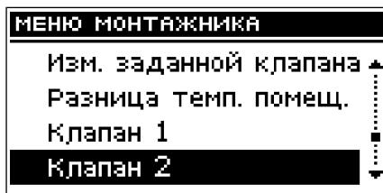
Если пользователь хочет управлять вторым опциональным клапаном, следует также, как и в предыдущем случае выполнить регистрацию клапана 2 (дополнительного) и соответствующим образом сконфигурировать все настройки аналогично как в случае клапана 1.
