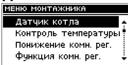
В этом субменю пользователь устанавливает основные параметры защиты котла и подключения насоса.
