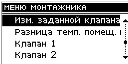
Данная настройка определяет, на сколько градусов температура клапана повысится или понизится при одиночном изменении температуры комнаты (см. *Разность температур помещения*). Эта функция активна только с комнатным регулятором TECH и тесно связана с параметром *Разность температур комнаты*). Настройка температуры клапана в этом случае производится непрерывно во времени.
