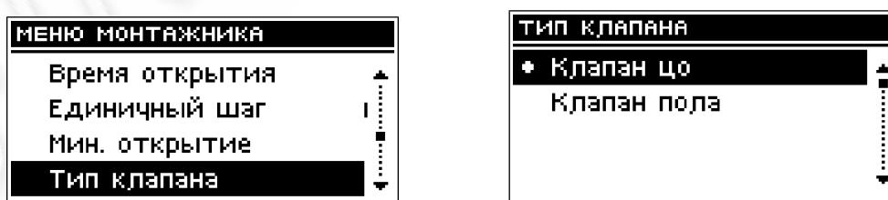
При помощи этой настройки пользователь выбирает управляемый клапан:
