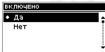
Данная опция служит для включения активности смещающего клапана. Когда клапан отключен, не работает также и насос. Кроме того что клапан отключен, после включения пульта управления в сеть всегда производится калибровка. Это делается для того, чтобы клапан не оставался в опасной позиции для системы циркуляции (см. раздел III.d).
