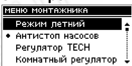
В этом режиме регулятор закрывает **клапан ЦО** чтобы без необходимости не отапливать дом, однако в случае достижения слишком высокой температуры котла (требуется подключение защиты возврата!) клапан будет открыт в аварийном режиме. Этот режим не активен при регулировании **клапана обогрева пола**.
