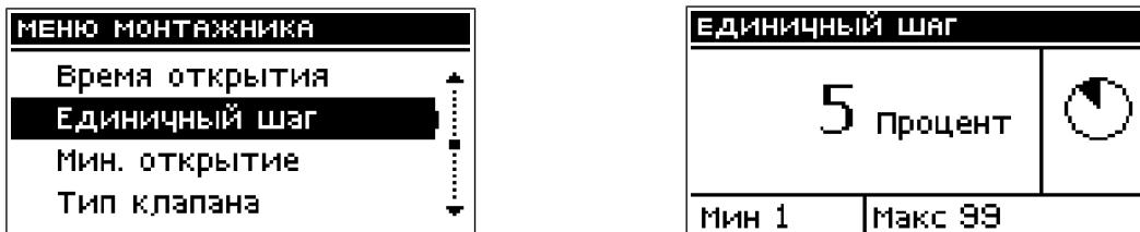
Это составляет максимальный одноразовый шаг (открытия или закрытия), который может выполнить клапан во время одного измерения температуры. Если показатель находится близко к заданной температуре, то этот шаг рассчитывается на основании параметра КОЭФ. ПРОПОРЦИОНАЛЬН. Чем меньше единичный шаг, тем точнее может быть достигнута заданная температура, однако на это потребуется более длительное время.
