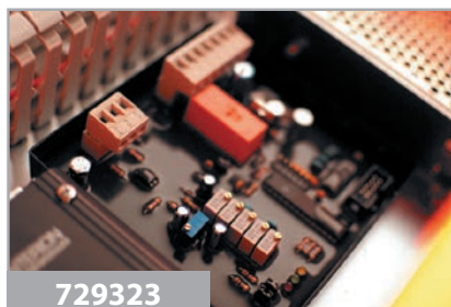
Контроллер ASC48-2 измеряет напряжение АКБ стойки питания и температуру в помещении/контейнере с со-блюдением режима зарядки, запускает и останавливает ДГУ.
