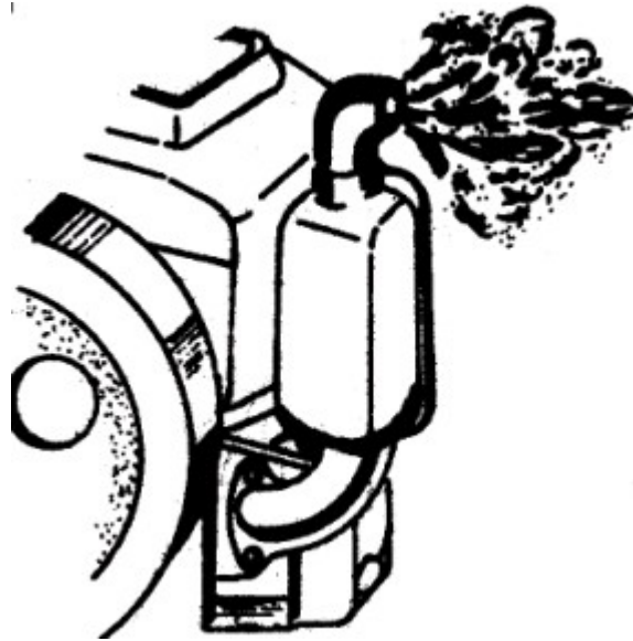
Рис. 13 Выхлопной газ черного цвета
