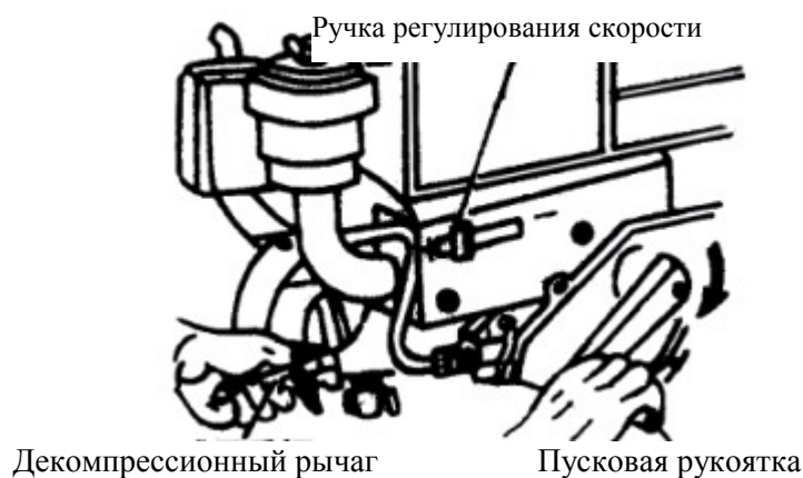
Рис. 11 Запуск двигателя при помощи ручной пусковой рукоятки
