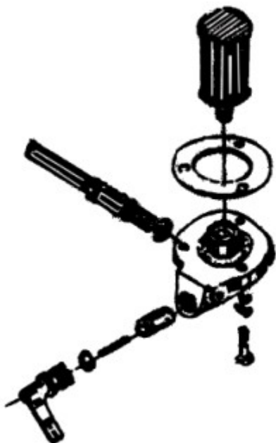
Рис. 9 Укомплектованный топливный фильтр (a) топливный фильтр модели 185-11200А (б) топливный фильтр модели 180N-10300С
