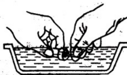
Рис. 21 Промойте корпус форсунки и игольчатый клапан
