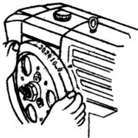
Рис. 18 Отметка ВМТ на маховике
