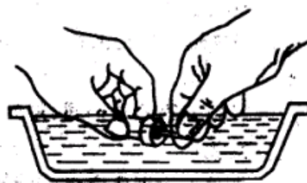
Рис. 21 Промойте корпус форсунки и игольчатый клапан
