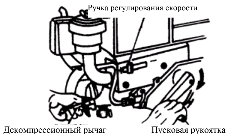
Рис. 11 Запуск двигателя при помощи ручной пусковой рукоятки
