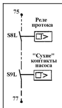
Рис. 11. Защитные устройства и их подключение к контроллеру чиллера.
