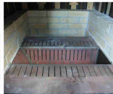
100% дожигание пиролизных газов инжекционного типа с функцией самоочистки
