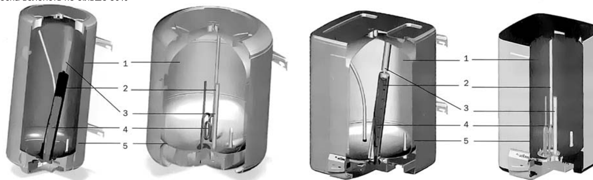
1. Внутрішній бак з емалевим покриттям 2. Трубка ТЕНа/фланця для датчика температури 3. Магнієвий анод 4. Нагрівальний елемент 5. Шар пінополіуретану
