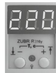
При включении устройства сразу начинает отображать значение напряжения сети. Если напряжение находится в допустимых пределах, включается нагрузка, и начинает светиться зеленый светодиод. Если напряжение сети превышает верхний предел или ниже нижнего предела, тогда напряжение на нагрузку не подается.
