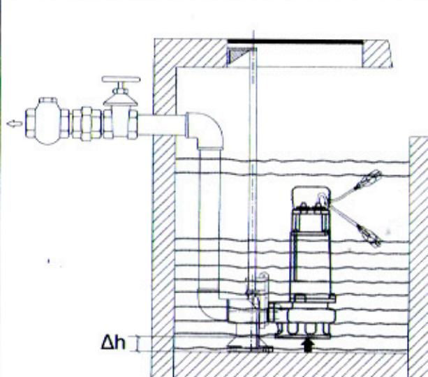
$\Delta h$  - высота насоса, на которую его необходимо поднять от дна во избежание попадания вовнутрь насосной части намывного ила или грунта.
