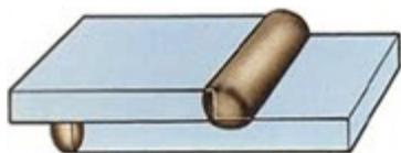
**Тавровое** сварное соединение, в котором торец одного элемента примыкает под углом и приварен к боковой поверхности другого элемента.
