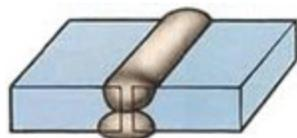
**Нахлесточное** сварное соединение, в котором сваренные элементы расположены параллельно и частично перекрывают друг друга.
