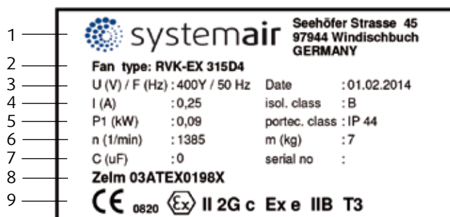
Bild 6: Typenschild der Baureihe RVK-EX
