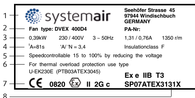
Bild 8: Typenschild der Baureihe DVEX
