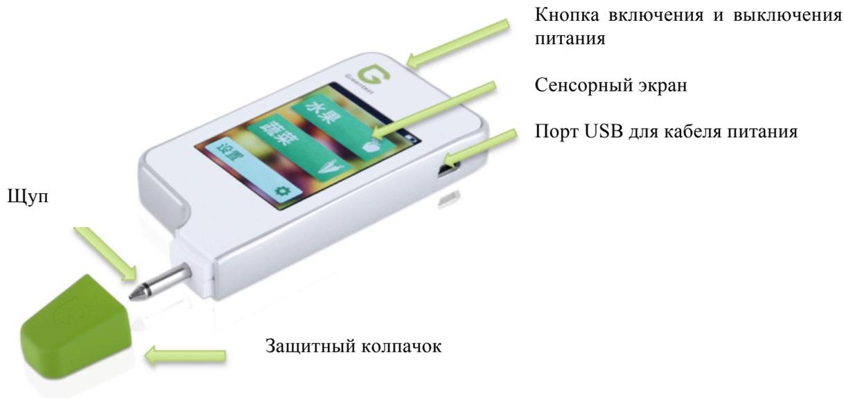
Рис. 1 - Схема прибора
