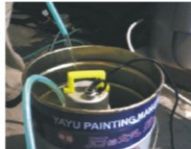
Закачка жидкости-теплоносителя с помощью погружаемого насоса
