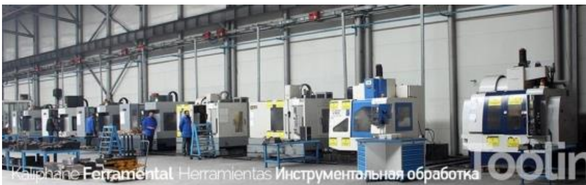
Послековки все заготовки проходят контроль качества и только после этого поступают в цех механической обработки для дальнейших производственных операций.
