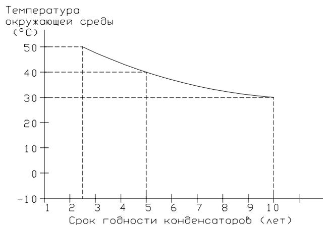
Здесь температура окружающей среды означает температуру вокруг корпуса инвертора. Если инвертор устанавливается в шкафу, под температурой окружающей среды следует понимать температуру в шкафу.
