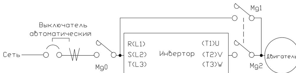
**ЗАМЕЧАНИЕ 2.** Установите автоматический выключатель на входе инвертора. (Выберите такой автоматический выключатель, уровень чувствительности по току которого поднят в область высоких частот.) При длине кабеля между инвертором и двигателем более 10 м в работе теплового реле могут происходить сбои из-за воздействия высших гармоник. Поэтому на выходе инвертора установите дроссель или используйте датчик тока в месте теплового реле.
