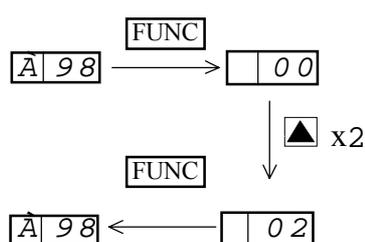
2. В режиме  $\boxed{\bar{A}}\boxed{98}$  установите  $\boxed{\phantom{0}}\boxed{02}$  (использование данных, полученных в результате выполнения автонастройки).
