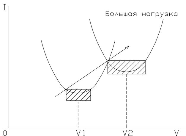
Когда нагрузка на двигателе постоянна, как показано на рисунке, на выходе инвертора устанавливается напряжение, при котором ток минимален. Следовательно, мощность также минимальна. Данная функция позволяет автоматически найти требуемое напряжение.
