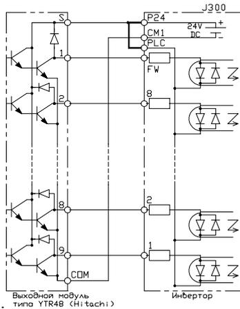
2. Ниже приведен пример подключения выходного модуля программируемого контроллера с использованием транзисторов истокового типа (с открытым коллектором).
