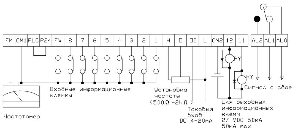
**ЗАМЕЧАНИЕ 1.** При использовании выходных информационных клемм обязательно установите полупроводниковый диод параллельно реле (RY). Иначе, всплески напряжения, возникающие при переключении реле из ON в OFF могут привести к выходу из строя цепи выходных информационных клемм.
