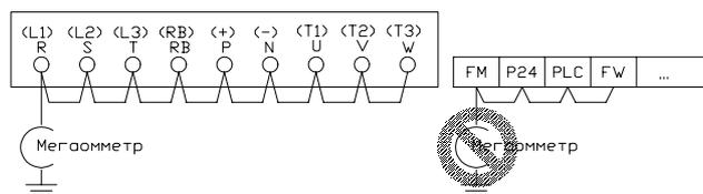
Удалите ZNR, подключенной к клеммам G(PE) и T(L3) перед выполнением теста. После испытания подключите ZNR опять.
