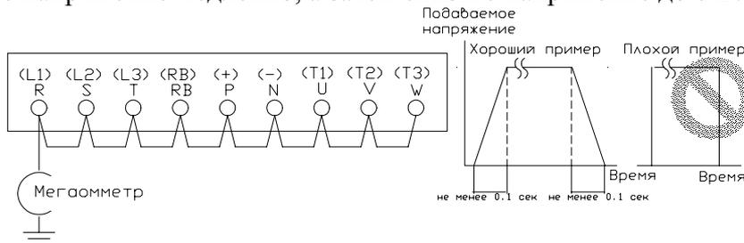
Перед проведением теста переключите ZNR, соединив клеммы G(PE) и T(L3).
