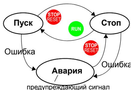
Необходимо различать аварийный сигнал AL и контакты сигнального реле [AL0], [AL1] и [AL2]. Сигнал AL является логической функцией, которую Вы можете установить на один из дискретных выходов или релейный выход. Наиболее часто на реле устанавливается функция Аварии AL. Исходя из этого, обозначаются контакты реле...
