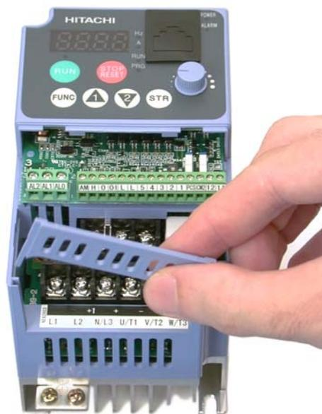
Питание и 3 фазы электродвигателя подключайте к нижней клеммной колодке. Верхняя клеммная колодка предназначена для подключения к дополнительному устройству динамического торможения.
