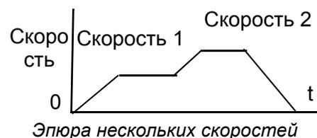
Инвертором можно задать вращение вала двигателя в любую сторону. Направление вращения определяют команды FW и RV. Пример эпюры показывает вращение вала в прямом направлении и в обратном направлении меньшей продолжительности. Аналоговый сигнал или значение фиксированной скорости управляют векторным значением скорости, а команды FWD и REV задают направление вращения.
