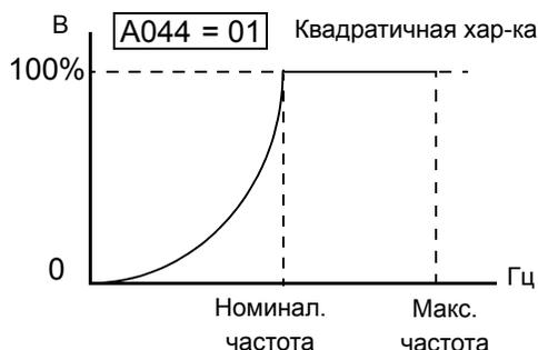
Ручное увеличение момента - при линейной и квадратичной хар-ках есть возможность увеличить момент. Когда нагрузка электродвигателя имеют большую инерцию или трение при пуске, Вам, скорее всего, придется увеличить пусковой момент на низких частотах путём увеличения напряжения выше обычного уровня в соотношении напряжение/частота (рисунок справа), для компенсации падение напряжения в первичной обмотке электродвигателя на низких скоростях.
