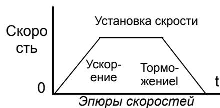
Параметры ускорения и торможения определяют время разгона от состояния покоя до максимальной частоты (или наоборот). Отношение изменение скорости к времени является ускорением или торможением. Время разгона или торможения до заданной скорости зависит от начальной и конечной скорости. Однако, коэффициент является постоянным, так как он относится к полному диапазону времени ускорения или торможения. Например, установлено время ускорения 10 секунд, это означает время разгона от 0 до 50 Гц.
