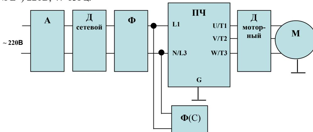
**II: Преобразователь частоты с трехфазным напряжением питания**
