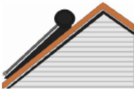
Гелиоприёмник, установленный на наклонной кровле.
