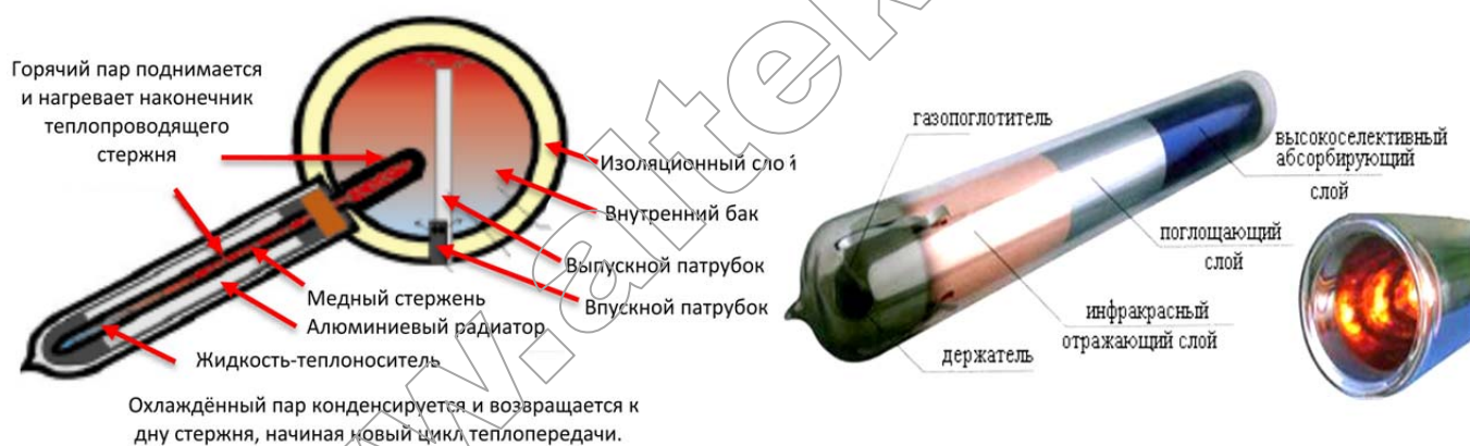
Рис. 1 Принцип нагрева и строение вакуумной трубки
