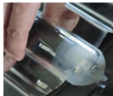
газопоглотитель разрушен, трубка неисправная
