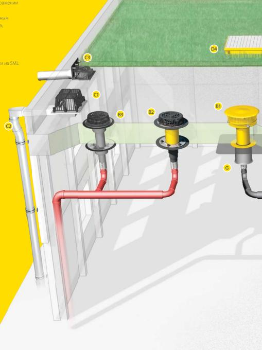
Классический или вакуумный водоотвод, аварийный водоотвод через парапетную стену или подпорные элементы, эффективная вентиляция плоских кровель или надёжный дренаж? Для каждой задачи Sita предлагает Вам надёжное и соответствующее нормам решение, будь то отдельное изделие или система.
