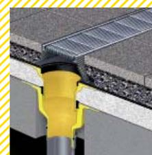
**Применение:** Для дополнения систем водоотвода балконов, террас, пешеходных зон и запасных выходов
