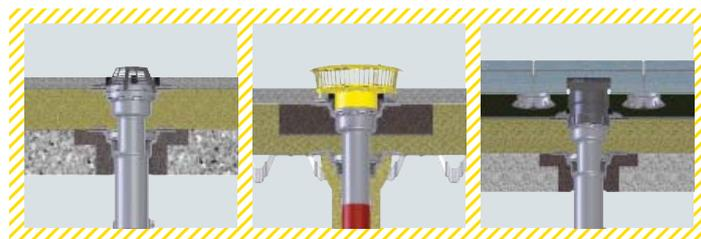
**Применение:** Для основного и аварийного водоотвода, а также для мероприятий по пожарозащите на больших эксплуатируемых и неэксплуатируемых кровлях
