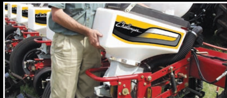
Семенной бункер может быть снят за считанные секунды без применения инструмента.
