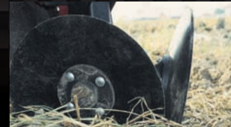
Дисковый измельчитель пожнивных остатков с дисками диаметром 300 мм.
