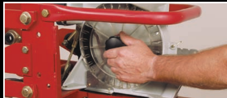
Диски дозирующих аппаратов также могут быть заменены в течение нескольких секунд.
