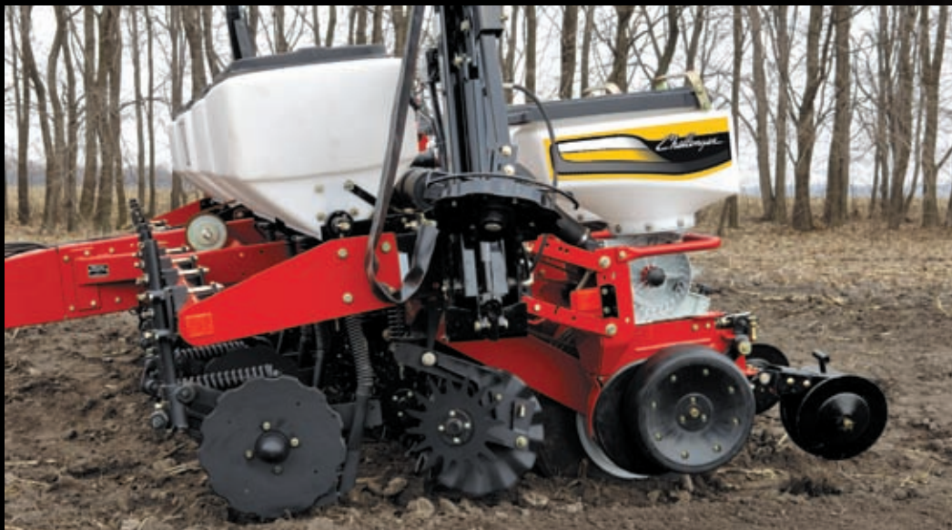
Приспособления на выбор, устанавливаемые на основную раму или на высевальные секции.
