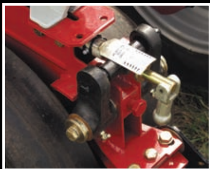
Точная регулировка глубины заделки семян.
