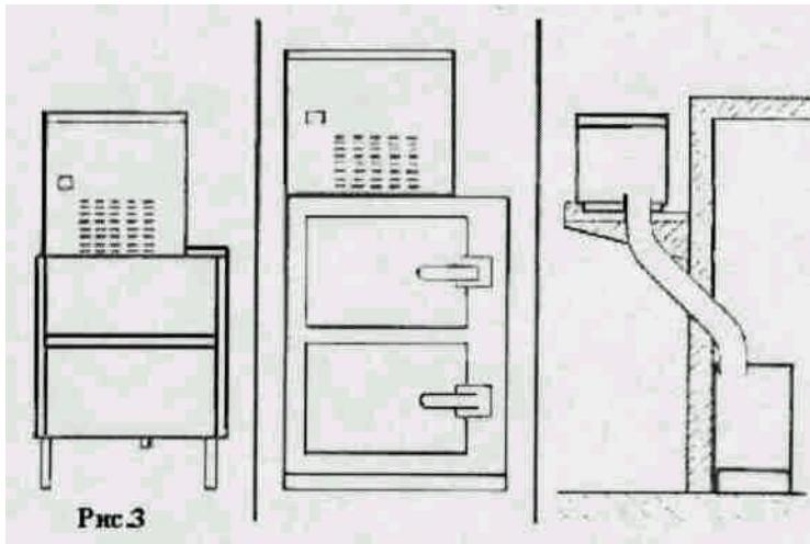
В любом случае убедитесь, что инструкции и предупреждения даны в этой инструкции, в особенности то, что касается подключения электричества и воды. (нагрузка/разгрузка воды). В случае, если автоматический льдогенератор установлен на каменную поверхность (платформу, кронштейн и т.д.) мы советуем вам внимательно изучить устойчивость и надежность данной конструкции при помощи технического эксперта. Для правильной установки
