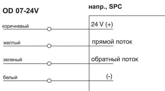
Схема подключения OD 07-24V
