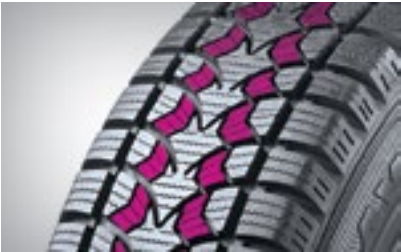
Стреловидные элементы: улучшенное рассечение рыхлого снега, грязи и воды
