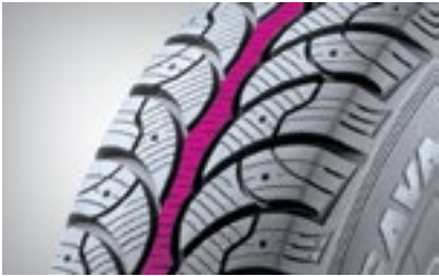
Сплошное ребро: повышение курсовой и боковой устойчивости на поворотах
