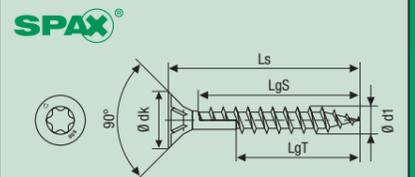
Потайная головка с фрезерными рёбрами, T-STAR T 50, закалено, агломерат с пластмассой, оцинковка, жёлтое пассивирование
