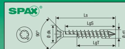
Потайная головка с фрезерными рёбрами, CUT-Остриё, T-STAR T 40 (8 мм) соотв. T 50 (10 и 12 мм), с закалкой, агломерат с пластмассой, оцинковка, жёлтое пассивирование
