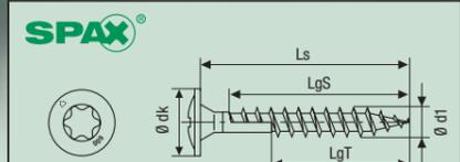
Тарельчатая головка, T-STAR T 50, с закалкой, агломерат с пластмассой, оцинковка, жёлтое пассивирование
