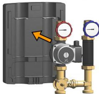
4). Переместите насос влево насосной группе, и повернуть рабочее колесо. Для осуществления данной операции открутите 4 винта, на которые указывают стрелки на рисунке, снимите рабочее колесо, поверните его на 180° и снова установите на корпусе насоса.
