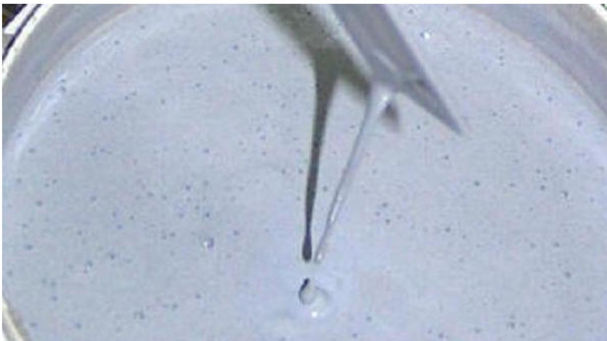
5. При нанесении КЕРАМОИЗОЛа при помощи пульверизатора, надо перелить подготовленный материал в новую тару используя фильтр с сеткой 0,5-1мм. Это предотвратит попадание мелких кусочков Керамоизола, которые могут забить пульверизатор.
