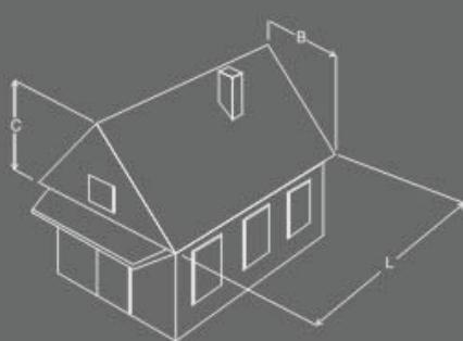
Эффективную поверхность крыши рассчитывают по формуле:  $E=(B+C/2) \times L$ .
