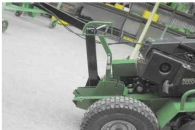
Установка рычага заглубления в положении UP
