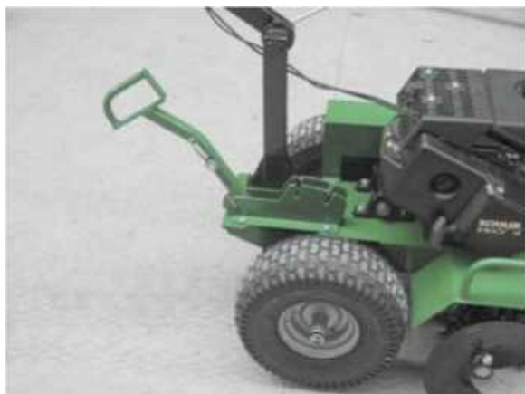
Установка рычага заглубления в положении DOWN
