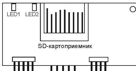
Рисунок 4. Расположение светодиодов на плате «VID-Universal»
